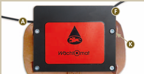
Abb. 6 Frontseite Sender mit Schutzplatte (und verdecktem Gehäusedeckel)
